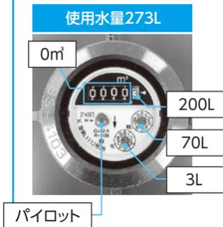
宅地内すべての蛇口を閉めても、水道メーターのパイロットが回っていれば、漏水が考えられます。お早めに指定給水装置工事業者へ連絡して修理を依頼してください。
