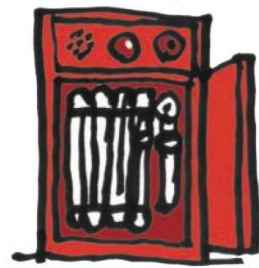
屋内消火栓設備
